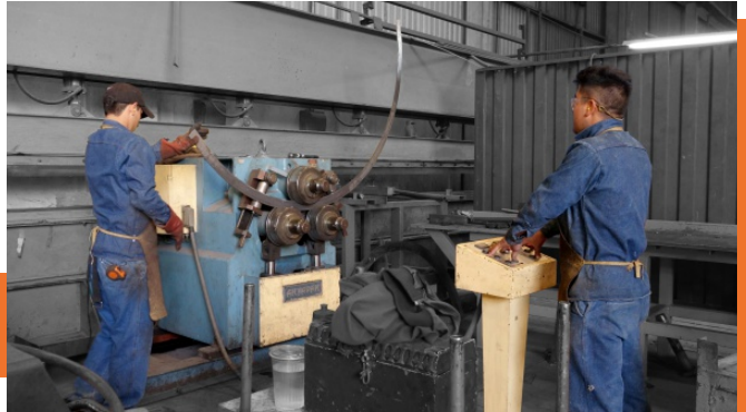
Rolado de cinchos de refuerzo
