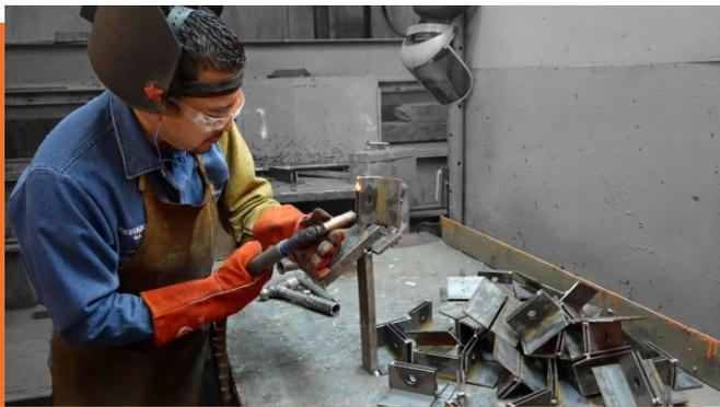
Ensamble de cuña para doble muro
