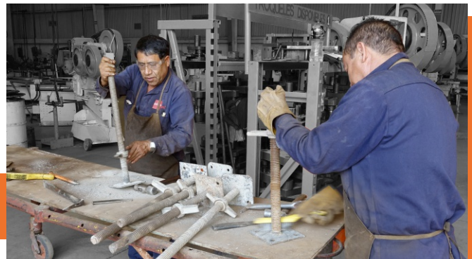
Limpieza de tornillo base
